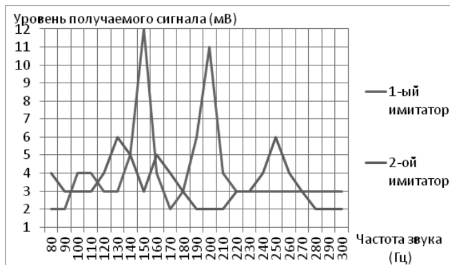
Рис. 10 – Графики АЧХ 1-го и 2-го имитаторов
