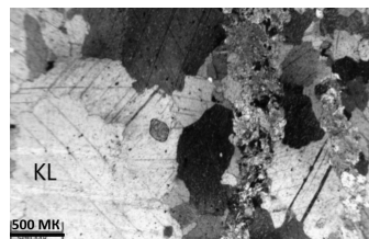
рис. 4 Рускеальский мрамор, расположение зерен кальцит, амфибола и хлорита. Фото шлифа, скрещенные николи
