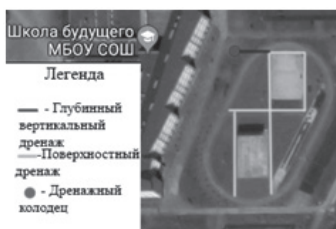
Рис. 11 Решение №2- глубинный вертикальный дренаж ветвистого расположения.
