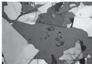
Рис. 12 Графеновые чешуйки на поверхности пластины Si/SiO 2 от ~ 100 нм – бледно-жёлтые, 200 нм – голубые, 300 нм – фиолетовые)
