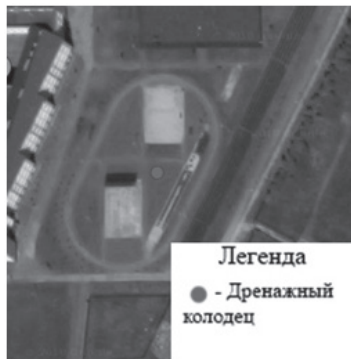
Рис. 13 Решение №4 – глубокий горизонтальный дренаж радиального расположения.
