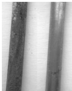
Рис. 3. Фотографии стальных стержней после 10 суток экспозиции в суспензии 3% раствора NaCl без противокоррозионного пигмента (слева) и с противокоррозионным пигментом (справа)
