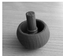
Рис. 1. Модель волчка с цилиндрическим вырезом и плоским концом ножки
