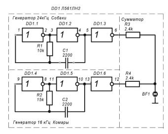
Рис.1. Принципиальная электрическая схема ультразвукового отпугивателя
